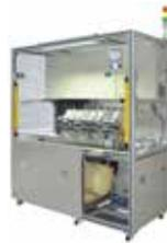
AGA300 应用于汽车传感器线束的橡胶套 Grommet 组装，例如轮数传感器线束，ABS 线束等。此机器为自动组装，当操作人员将线插入第一个型腔后，机器将自动完成所有的橡胶套组装。机器的平台概念和膨胀原理保证了每个橡胶套在线束上的为主的准确和一致性。
