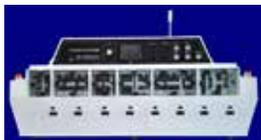
洗系统，可以去除电子产品里面的各种残留物，包括但不限于：水溶性残余物、RMA（中等活性松香）、免洗无铅助焊剂、电镀盐、指印、灰尘和散锡球等。此清洗机采用美国 TDC 在线中低压大流量清洗工艺理念设计，具有清洗效率高，成本低等特点，喷嘴喷管均采用人性化设计，安装维护方便，具有价格优、性能好、清洗效果好、高性价比等诸多特点。设备整体材料为聚丙烯，能够抵抗化学品的侵蚀，经久耐用，持久如新。整机采用 PLC+触摸屏人性化控制，操作系统直观易操作。
