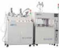
鑫路远全自动真空双液灌胶机是由双液灌胶系统和真空灌注系统组合而成。双液灌胶系统是采用 PLC 进行控制，由气缸、步进马达马达控制计量泵的比例。胶水储胶罐可以加装搅拌、
