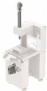
Festo 的压配组件 YJKP 可为多种应用提供预装配且简单的系统解决方案,如印刷电路板压入壳体、精密零件插入时钟机构、密封模块壳体或压配并测试密封件等。该组件由模块化的操作软件和匹配的 Festo 标准元件组成 - 包括丝杆式电缸 ESBF、电机 EMM5-AS、电机控制器 CMMP-AS、控制器 CECC-X 和力传感器。电子元件和小零件制造行业的机器制造商和工厂建造商可将该系统解决方案快捷地植入进自己的压配应用中。
