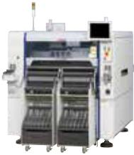
可高效大范围支持各式生产形态;拥有同级产品中世界最快速的万能型表面贴片机;由1台贴装头同时实现高速性与通用性,提供理想的解决方案;可贴装的元件范围广,具体实现“Limitless EXpansion”;多项功能作为标准配置,
