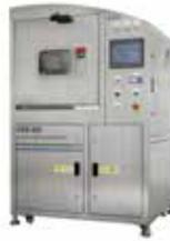
针对中小产能的 PCBA 助焊剂清洗设备。典型的批量清洗工艺，KED 600 在一个清洗腔体内实现清洗，漂洗和烘干全过程。其根据客户具体使用情况以及结合其它清洗设备的优点所设计出的新型高效的第三代 PCBA 离线清洗机。此设备通过改用 SUS304 不锈钢整体外形、卧式泵、内外双层焊接箱体、
