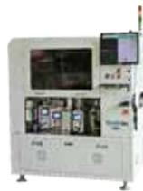
创达 OIM-2 异型插件机，该设备配备 2 个检测相机，及零件高度检测系统，机身采用整体焊接工艺，配备日本精密运动控制机构，能精准、快速完成零件的插入，实现插件速度 2000~6000PCS/小时。配备了编带料、散带料、托盘料、卷带料、管装料供料系统。
