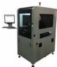
CMS-420 在线喷码机是 VECTRON 公司采用智能化平台 CMS+ 搭载英国品牌多米诺喷码机的一款应用于 SMT 在线设备。其结构采用龙门式、结构简单、稳定可靠、便于维护等等。机台采用标准 SMEMA 通讯系统，便于前后设备通讯。
