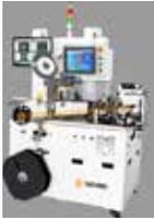
SKD960 是一种高速测试分选机, 采用了多功能的转塔系统, 应用于表面贴装半导体器件生产的最后工序, 能全自动完成器件的电参数测试、分类、激光打标、标识检测、外形尺寸六面检测及最终编带输出。
