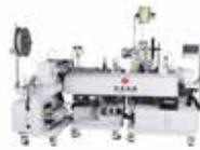
在国内首次实现了线缆的自动切断剥皮、扭线、端子自动压着以及热缩管的自动送料、切断、穿套、热缩成型、线上套黄腊管等连续自动化加工。采用光电传感技术，产品缺件自动检测，设备故障自动判定报警。采用 PLC 控制，结合编码器，生产数据实时记录，可任意设定产品所需规格，功能多样化，适应范围广。生产效率高，性能稳定，节省人工，节能降耗。
