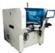
域的应用解决方案, 提供从方案设计, 加工制造, 装配调试到售后服务的一站式服务。目前我公司业务主要集中在插件工艺的自动化解决方案, 提供包括高速异形插件机等在内的整线自动化解决方案。重点单项智能装备 -- 高速异形元件自动贴插机, 本设备为业内最高速异形元件贴插机, 最高贴插速度可达 5000 点/小时, 广泛用于电源、主板、通讯产品等的异形元件自动贴插作业。高速高精度, 大量替代人工作业, 确保作业品质。
